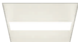
LF1 Finitura pannelli: Acciaio satinato Asturia (F) Lamiera verniciata Opaco Bianco (P50) Illuminazione: luce diretta fluorescente; a seconda della profondità della cabina può essere provvisto di 1, 2 o 3 corpi illuminanti
