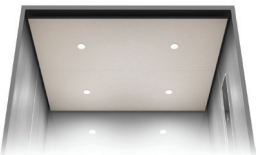
CL80 Finitura: Lamiera verniciata Bianco Cachemire P63, Acciaio satinato Asturia F Illuminazione: Faretti a LED, tondi Nota: Disponibile versione CL80FFL con botola e scala e versione CL80FF solo con botola, entrambe conformi alla norma EN81-72 antincendio. Disponibile versione CL80V conforme alla norma EN81-71 antivandalo cat. 1 in acciaio satinato Asturia F
